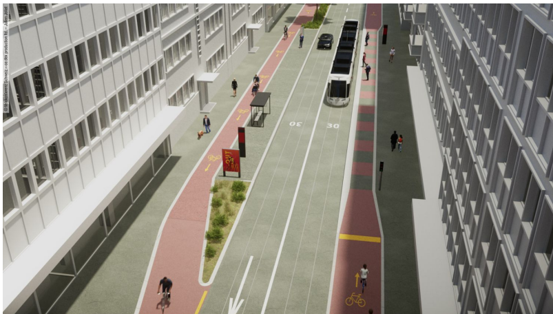
Illustration de deux variantes d'un guidage optimal des vélos le long des arrêts de transports publics. Source: Conférence Vélo Suisse
