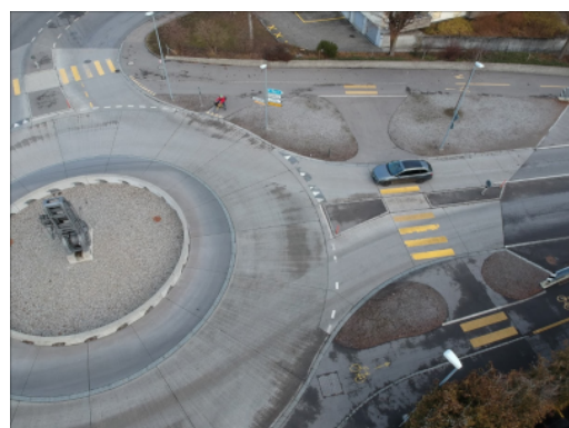
Giratoire "Schachenkreisel" avec pistes cyclables séparées à Lyss
