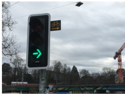
Zusatztafel rechts abbiegen für Velos bei Rot erlaubt. Einfahrt Schützenmattstrasse, Bern
