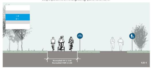
Beispielquerschnitt Zweirichtungsradweg. Quelle: Kanton Zürich
