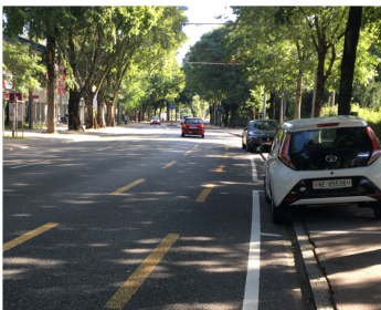
Radstreifen mit Sicherheitsabstand zu parkierten Autos, Biel
